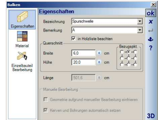
Eigenschaften Bauteil mit aktivierter Bezeichnung für die Ausgabe in der HL. Eingabe manuell oder über Mehrfachauswahl und Eigenschaften übertragen.
